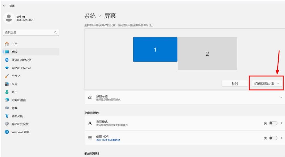
点识别或标识，通常 1 显示器对应 ASTER 面板中的 1.1 显示器图标，2 显示器对应 1.2 显示器图标，如果有 1.3 显示器图标是灰色的，表示显卡有第三个输出接口，只是没有连接显示器，如果是 2.1 / 2.2 显示器图标表示另外一个显卡上的两个显示器，说明这台电脑有两个显卡如独立显卡和集成显卡。
